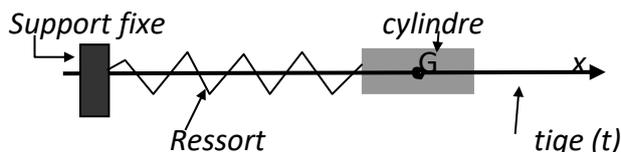
Le mouvement du cylindre le long de la tige métallique s'effectue avec frottement visqueux dont la somme des actions est représentée par une force unique  $\vec{f} = -\alpha \vec{v}$ , où  $\vec{v}$  est la vitesse instantanée du centre d'inertie du cylindre. On écarte le cylindre de sa position d'équilibre en déplaçant son centre d'inertie  $G$  d'une distance  $x_0 = +5 \text{ cm}$  puis on l'abandonne sans vitesse initiale à une date prise comme origine des dates.
